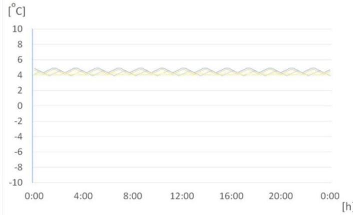
با استفاده از اوپراتور یکپارچه و سیستم Multi Air Flow مقدار ریزش برودت و الگوی گردش هوا در تمامی طبقات تقریباً برابر می‌باشد این عوامل در کنار استفاده از سه عدد فن سرعت بالا برای به گردش در آوردن هوا و همچنین برخورداری از کنترلر دمایی دقیق تضمین کننده دمایی با اختلاف کم بین طبقات است.
