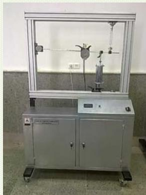
قابلیت تحلیل و رسم نمودار زاویه پیچشی شفت مورد آزمایش (نمودار میرای پیچشی) و پروتکل ارتباطی RS-232 برای نمایش در کامپیوتر
