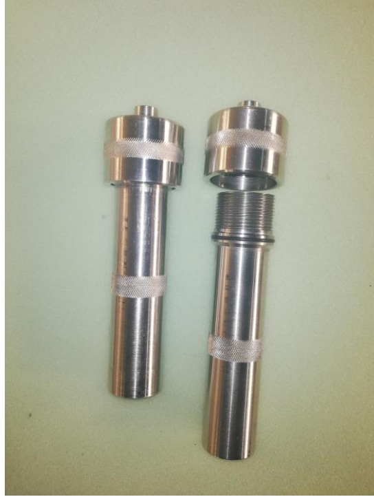
شکل ۳. چمبر تست فشار پایین
