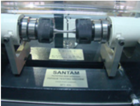
دستگاه تست خستگی ۴ نقطه‌ای
