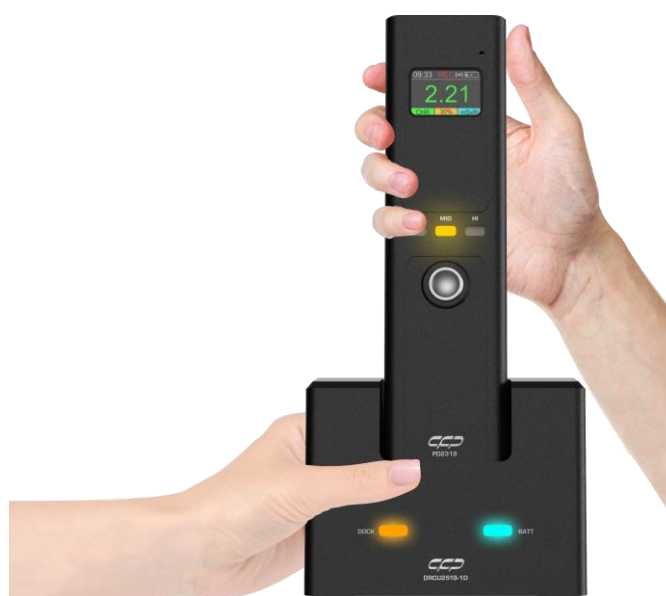
شکل ۳۰ نحوه صحیح برداشتن دزیمتر از روی داک به کمک هر دو دست
