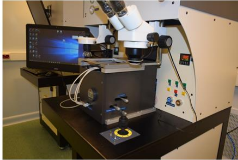
سامانه اپتیکی قادر به مشاهده یک نقطه از نمونه یا ماسک
