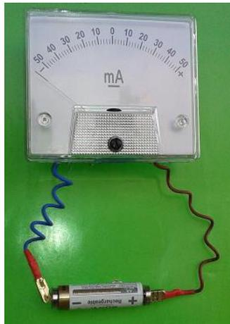
اگر دو سر گالوانومتر را به دو سر باطری وصل کنیم مشاهده می کنیم که عقربه گالوانومتر به شدت منحرف می شود. حال اگر جای قطب های باطری را عوض کنیم عقربه به سمت راست منحرف می شود.
