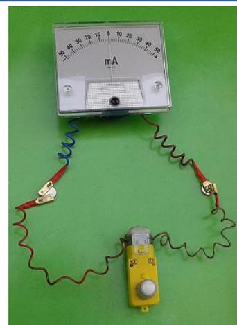
دو سر یک مولد الکتروسیته را به گالوانومتر وصل می کنیم با چرخاندن مولد الکتریکی عقربه گالوانومتر به شدت منحرف می شود شبیه حالتی که به باطری وصل شد
