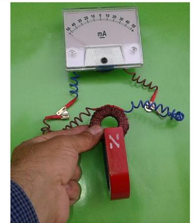
در این آزمایش از سیم پیچ 300 دور و آهنربای تقویت شده استفاده می کنیم و مشاهده میکنیم میزان القاء خیلی زیاد می شود
