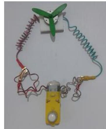
در اینجا دو سر مولد الکتریکی را به موتور الکتریکی وصل کرده و آنرا می چرخانیم مشاهده می کنیم که موتور الکتریکی می چرخد همانطور که موتور به باطری وصل شد
