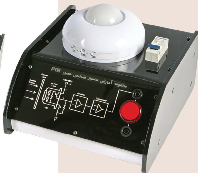
ماژول سنسور تشخیص حضور (PIR) مدل : MS02-PIR
