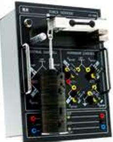
این ماژول که قسمت اصلی این سیستم آموزشی نیز محسوب می‌شود به کمک چندین استرین گیج نصب شده بر روی سطوح مسطح و استوانه‌ای شکل، مفهوم اندازه‌گیری نیرو و بطور خمی و پیچشی را به کاربر منتقل می‌کند. همچنین یک عدد لو DSL به همراه
