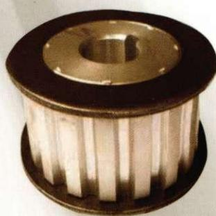
تسمهه تایم این حرکت از جنس اورتان(Urethane) می باشد که به دلیل وجود سیم های نازک داخل آن، باعث افزایش عمر آن در مقابل پاره شدن نسبت به تسمهه های معمولی لاستیکی شده است. پولی ها برای سبکی و روانی حرکت از جنس آلومینیوم انتخاب شده است. تمامی سوراخکاری برای نصب قطعات توسط دستگاه های برش و تراش CNC انجام شده است.
