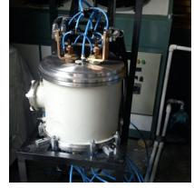
سیستم بعد از ساخت تحت تست هلیوم جهت نشت یابی قرار می گیرد.
