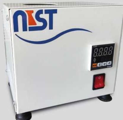
استریلایزر وسیله‌ای مناسب جهت جایگزین چراغ‌های الکلی و شعله‌های گازی زیر هود می‌باشد که توسط یک ظرف استوانه‌ای شکل که دمای تا 250 درجه سانتیگراد بالا رفته و موجب گرم شدن گلسبید داخل استوانه می‌شود و کاربر می‌تواند به راحتی قیچی و پنس خود را در زیر هود ضدغونه کند و هیچگونه خطر آتش‌سوزی ندارد و یک وسیله‌ای امن برای کابر می‌باشد.
