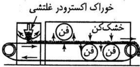
(الف) مسیر حرکت بستر نفوذپذیر در یک خشک کن ۳ واحد با گردش یکسره
