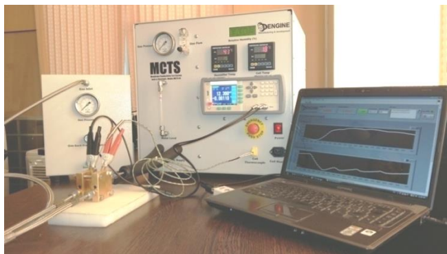
دستگاه اندازه گیری مقاومت الکتریکی مواد عایق، MTS-IC
