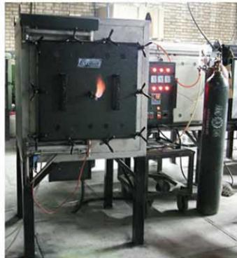
کوره الکتریکی  $1400^{\circ}\text{C}$  با اتمسفر هیدروژن خالص
