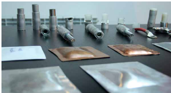
شکل دهی ورق های فلزی (لوگوی شرکت) بدون نیاز به سنبه و ماتریس
