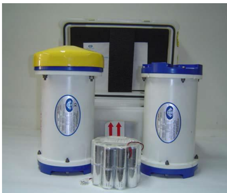
شکل ۳: دستگاه اندازه‌گیری موج و جریان ADCP ساخت شرکت RD INSTRUMENTS آمریکا
