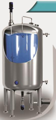
**میکسر مغناطیسی****Magnetic Mixer**[www.ksph.ir](http://www.ksph.ir)
