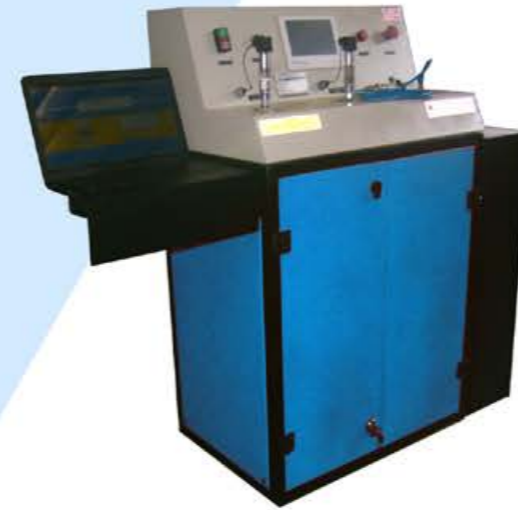
دستگاه تست و کالیبراسیون ترنسیتورهای فشار هواپیمایی
