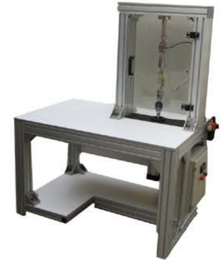
دستگاه تست مکانیزم چتر نجات پهباد
