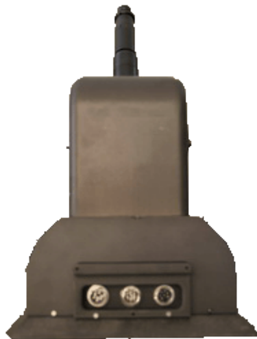
شکل ۱-۰ محل اتصال فیش های ۱۰،۵،۷ بین در پشت جعبه مکانیک
