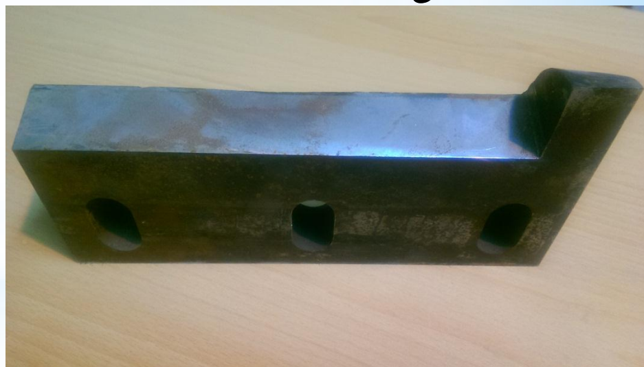
تیغه برش قیچی پروانه ای برای خط ترمکس با سه لوبیایی بعد از ۹۲۰۰ تن تولید
