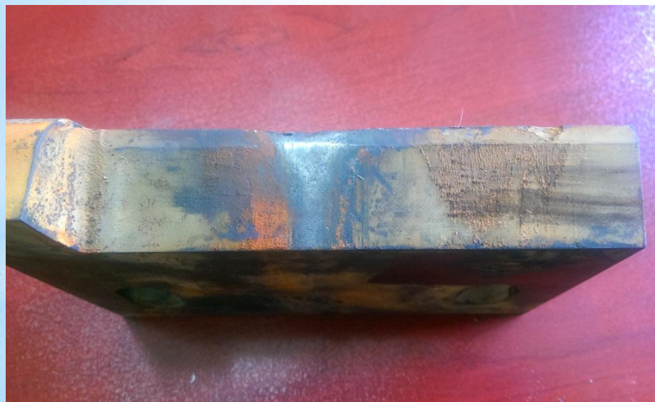
تیغه برش قیچی پروانه ای برای خط ترمکس با دو لوبیایی بعد از ۳۲۰۰ تن تولید
