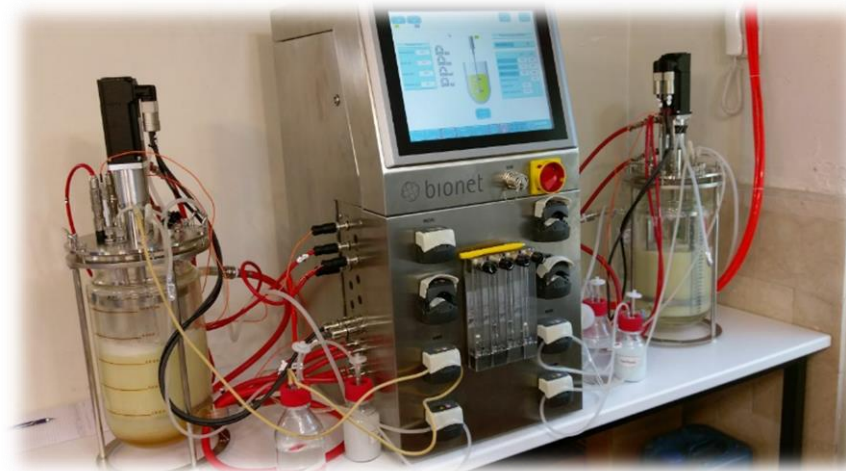
شکل ۲: فرمانتور دو قلو برای کشت های میکروبی موجود در شرکت کارین فرآیند سینا
