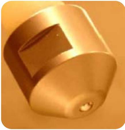
شکل ۱- تصویر محل قرارگیری پین/ گلوله و نمونه سایش، مسیر سایش، جهت چرخش دیسک و نیز نگهدارنده‌ی پین/ گلوله.
