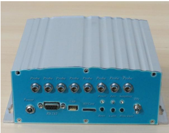
دستگاه کرنش سنج به همراه دیتالاگر رومیزی
