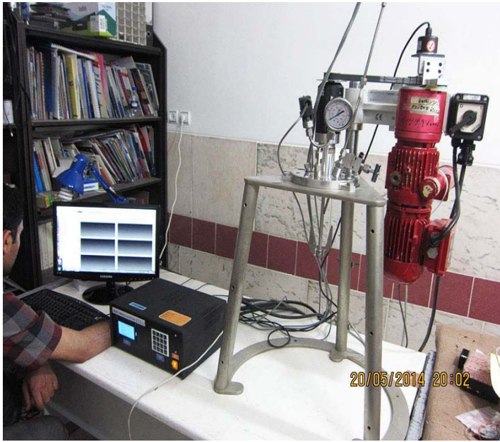
درپوش محفظه، سنسورها و موتور محرک راکتور در شکل‌های بالا دیده می‌شوند.
