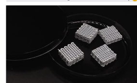
پرینت تابشی با ۷۱ درصد TiO۲ و تکرارپذیری بالا پروژه مشترک با دانشگاه صنعتی بیرجند
