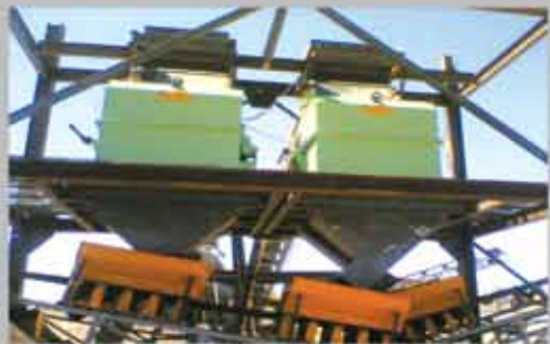
ساخت و نصب استراکچرها ، شوتها و نصب جداکننده های مغناطیسی شرکت سنگ آهن نگین معادن احیا- ۱۳۸۶
