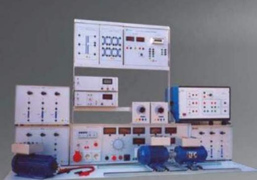
ست کامل آزمایش ماشین های الکتریکی DC و AC
