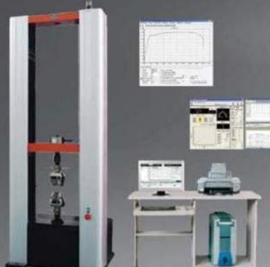
دستگاه تست کشش الکترونیکی
