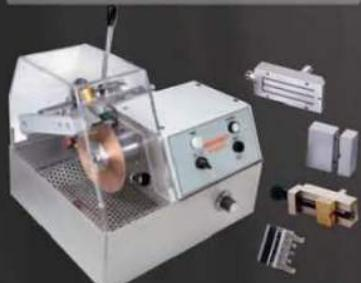
میکرو کاتر دستی با گیره های مختلف جهت برش دقیق قطعات کوچک
