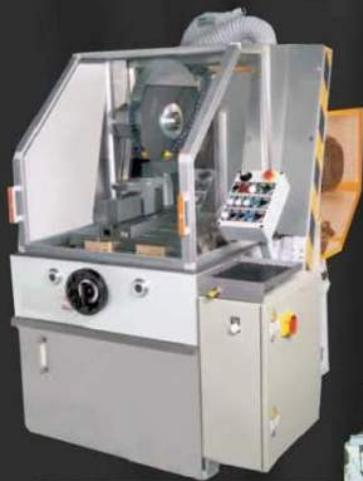
کاتر تمام اتوماتیک با قابلیت کنترل سه محوری با قطر برش تا ۵۰۰ میلی متر
