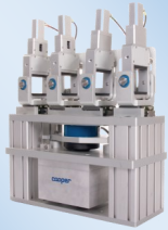
آزمایش خستگی تیرچه
