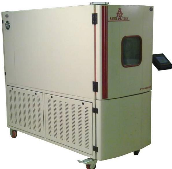
اگر چمپر ها ، به رنمه شده نمونه ها ای اولوچه می باشد و دما و رطوبت لازم را در تست ها ای طولاری مدت تامین کرده و همچنانه مجهز به سیستم ضد رطوبت می باشد ، تا این قابلیت نوز برای کاربر فراهم شود که رطوبت ها ای پایین تر از رطوبت محیط را ایجاد نماید .
