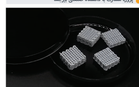
پرینت تابشی با ۷۱ درصد TiO۲ و تکرارپذیری بالا پروژه مشترک با دانشگاه صنعتی بیرجند
