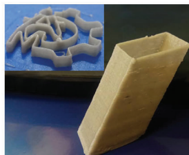
پرینت تابشی قطعات پیچیده بدون ساپورت طرح مشترک با پژوهشگاه پلیمر و پتروشیمی ایران
