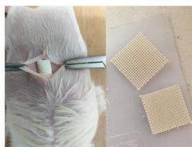
نمونه حاوی ۴۴ درصد کیتوسان و آزمون تخریب پذیری بالینی آن طرح مشترک با دانشگاه علوم پزشکی اصفهان
