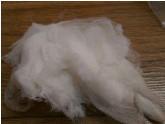
حجم تولید الیاف توسط دستگاه فورس اسپینینگ در زمان یک دقیقه
