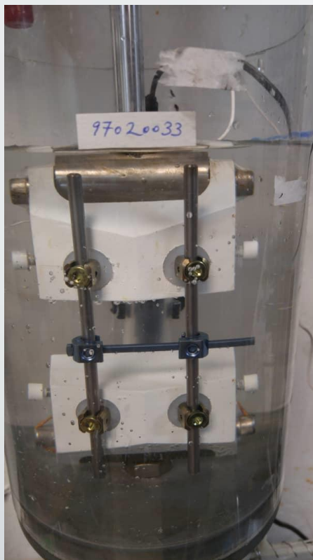
تست خستگی ایمپلنت نخاعی تست در محفظه با محلول و کنترل دمایی فرکانس ۵ هرتز
