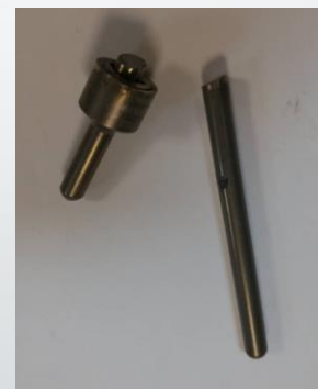
تست خستگی راد داینامیک تست با فیکسچر خمش سه نقطه ای فرکانس ۱۵ هرتز
