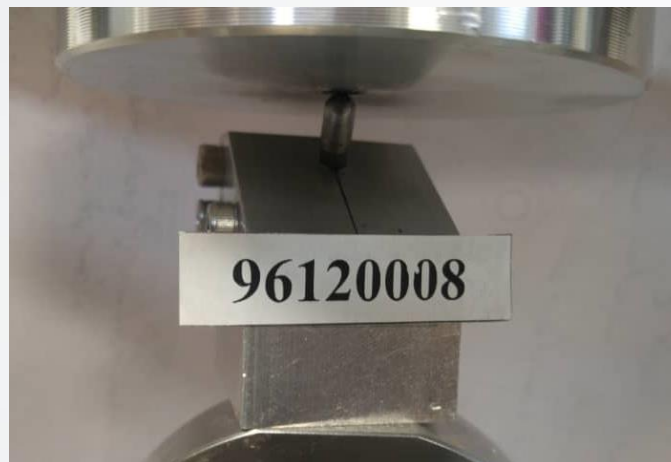
تست خستگی ایمپلنت دندانی تست با فیکسچر زاویه دار فرکانس ۱۰ هرتز
