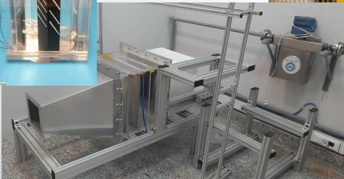
تست ریگ ترنزینت بررسی راندمان خنک کاری داخلی به صورت یکپارچه
