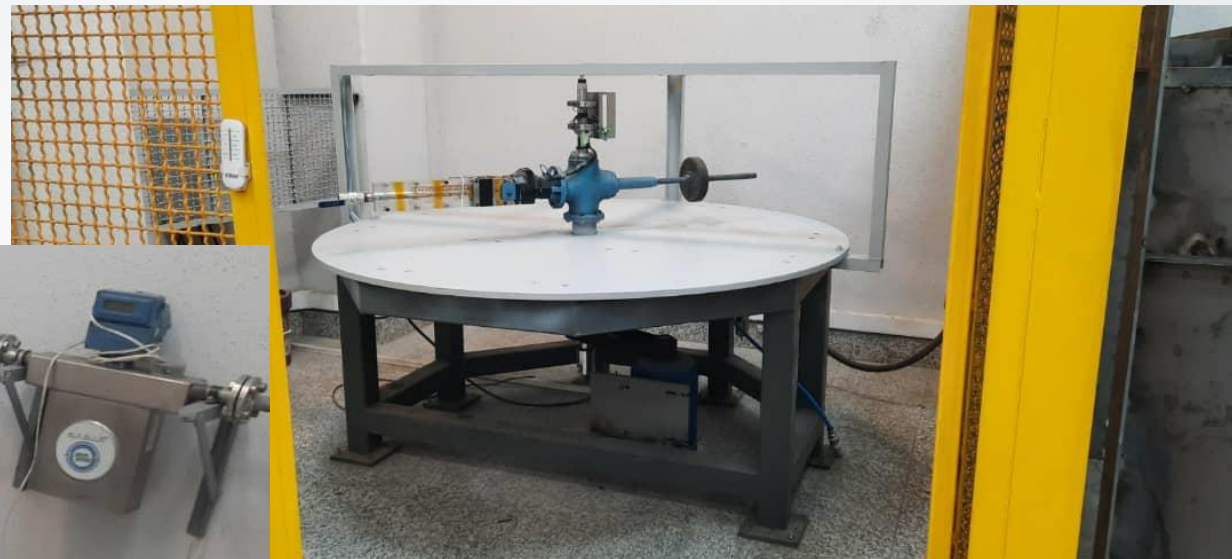
تست ریگ بررسی ریبهای خنک کاری داخلی پره در حالت ثابت و دورانی
