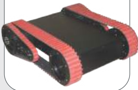
پلتفرم ربات امدادگر کنترل شونده از راه دور (TITAN)
