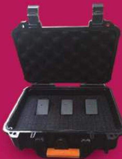
سامانه ثبت حرکت نما شامل استودیوی انیمیشن‌سازی نما و خانواده‌ای از سنسورهای زاویه‌یاب (AHRS) سبک با قابلیت نصب بر روی لباس و اعضای بدن انسان است. هر سنسور زاویه‌یاب با بهره‌گیری از سنسورهای سه محوره شتاب‌سنج، مغناطیس‌سنج و ژاپروسکوپ و با کمک الگوریتم‌های زاویه‌یاب مبتنی بر فیلر کالمون، زوایای نسبی را نسبت به یک مرجع مشخص و به صورت زمان حقيقی نشان می‌دهد.
