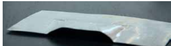
ورق آلومینیومی شکل داده شده با دستگاه MPS-5
