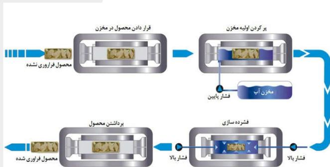
فشار تا ۶۰۰۰ بار اعمال فشار ایزو استاتیک و دمای آدیاباتیکی به صورت یکنواخت استفاده از ترکیب آب ضد زنگ و روغن قابل حل به عنوان سیال فشرده سازی حفظ طعم تازه و بافت محصولات به دلیل حرارت ورودی پایین افزایش سلامت میکروبیولوژیکی و عمر مفید با غیرفعال شدن پاتوژن ها، ارگانسیم های فساد و بعضی از آنزیم ها تولید غذاهای جدید مانند محصولات ژله شده هزینه کارگری پایین برای محصولاتی مانند غذاهای دریایی انرژی مصرفی پایین و پساب کمینه
