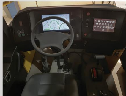
استفاده از ادوات داخلی خودروهای واقعی در کابین شبیه‌ساز
