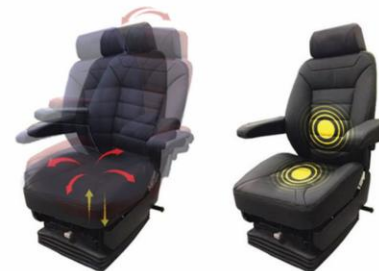
پیاده‌سازی سیستم حرکتی دو درجه آزادی برای صندلی اپراتور و لرزشگر صندلی به صورت بومی
