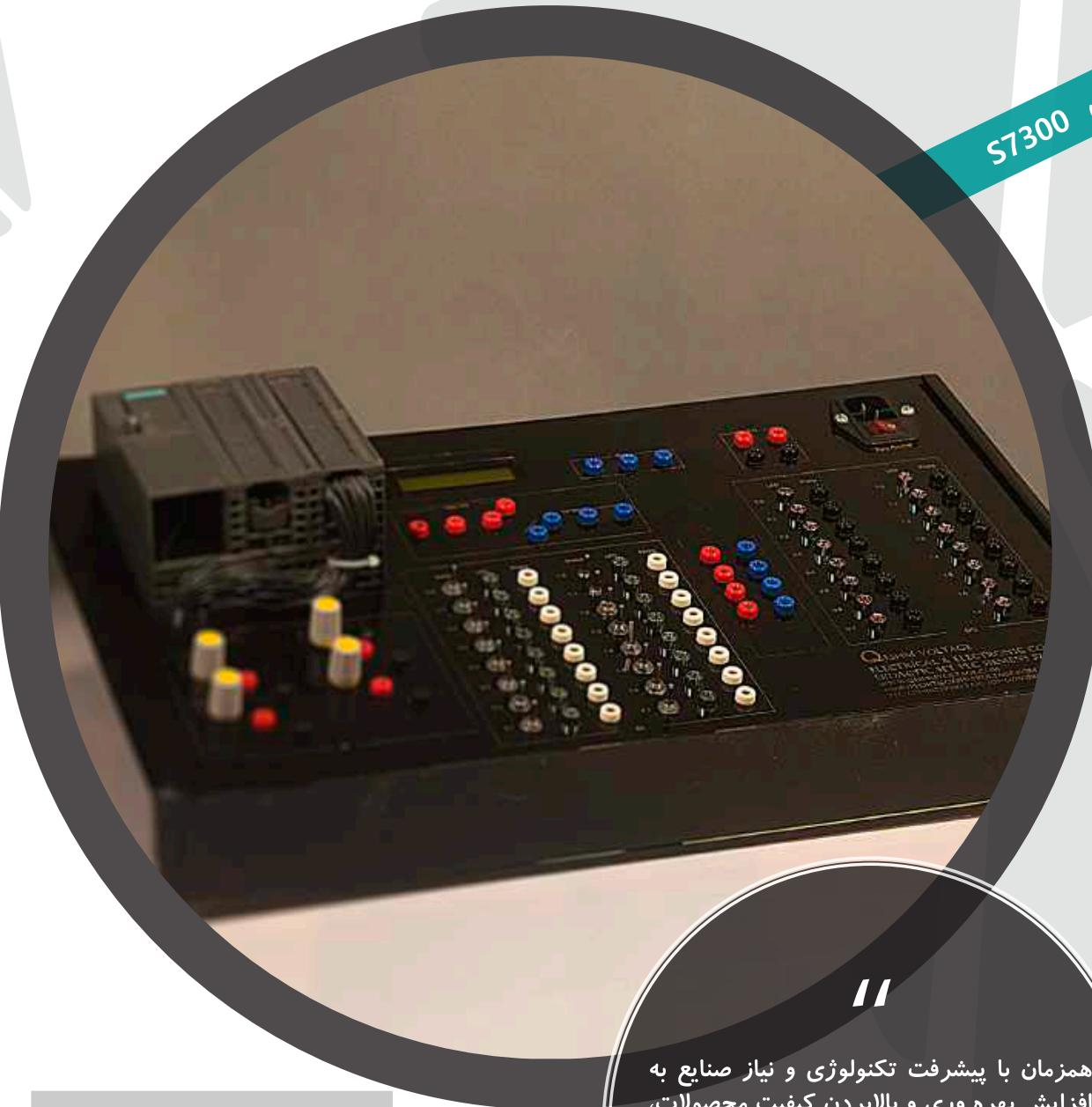
مناسب برای آموزش در نصب و راه اندازی سیستم اتوماسیون و بهره برداری دارای ورودی خروجی های آنالوگ و دیجیتال ۱۶ عدد ورودی و ۱۶ عدد خروجی دیجیتال و ۴ عدد ورودی آنالوگ و ۲ عدد خروجی آنالوگ دارای صفحه نمایش LED جهت خواندن اطلاعات ورودی/خروجی آنالوگ
