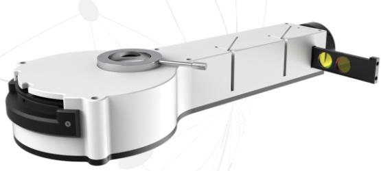
ماژول مبدل میکروسکوپ نوری به فلورسنت، دارای قابلیت نورتابی یکنواخت می‌باشد. این ماژول دارای یک منبع نوری، دیافراگم روزنه و دیافراگم میدان قابل تنظیم توسط کاربر، مجموعه‌ای از فیلترهای ND و فلورسنت است. ماژول فلورسنت به گونه‌ای طراحی شده است که می‌تواند از طریق آداتپور زیرین خود بر روی بدن میکروسکوپ‌های نوری Infinity-corrected Upright و تصویربرداری نوری میکروسکوپ کاملاً حفظ می‌گردد.
