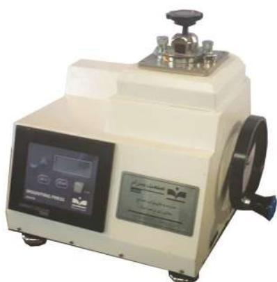
این دستگاه به منظور مانت کردن نمونه های متالوگرافی بکار میرود. ابتدا نمونه داخل استوانه دستگاه قرار میگیرد، سپس به اندازه کافی پودر مواد پلیمری داخل استوانه ریخته می شود. سپس در حالیکه نمونه تحت فشار قرار دارد حرارت داده شده و نمونه مانت می شود.
