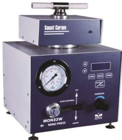
این دستگاه به منظور مانت کردن نمونه های متالوگرافی بکار می رود. ابتدا نمونه ای داخل قالب با حرارت دادن مواد پلیمری، مانت شده سپس با استفاده از سیستم گردش آب سریعاً تا دمای محیط خنک می شود.
