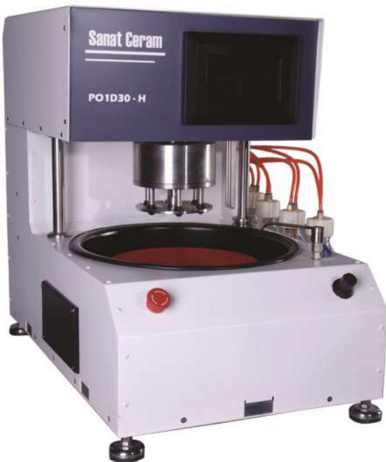
این دستگاه برای پرداخت نهایی نمونه های متالوگرافی مورد استفاده قرار میگیرد. سرعت دوران این دستگاه قابل تنظیم است. با استفاده از سیستم هولدردار می توان بدون نیاز به اپراتور نمونه ها را پرداخت نهایی کرد و همچنین این دستگاه در دو مدل قطر دیسک ۲۰ و ۳۰ سانتیمتر قابل ارائه می باشد.
