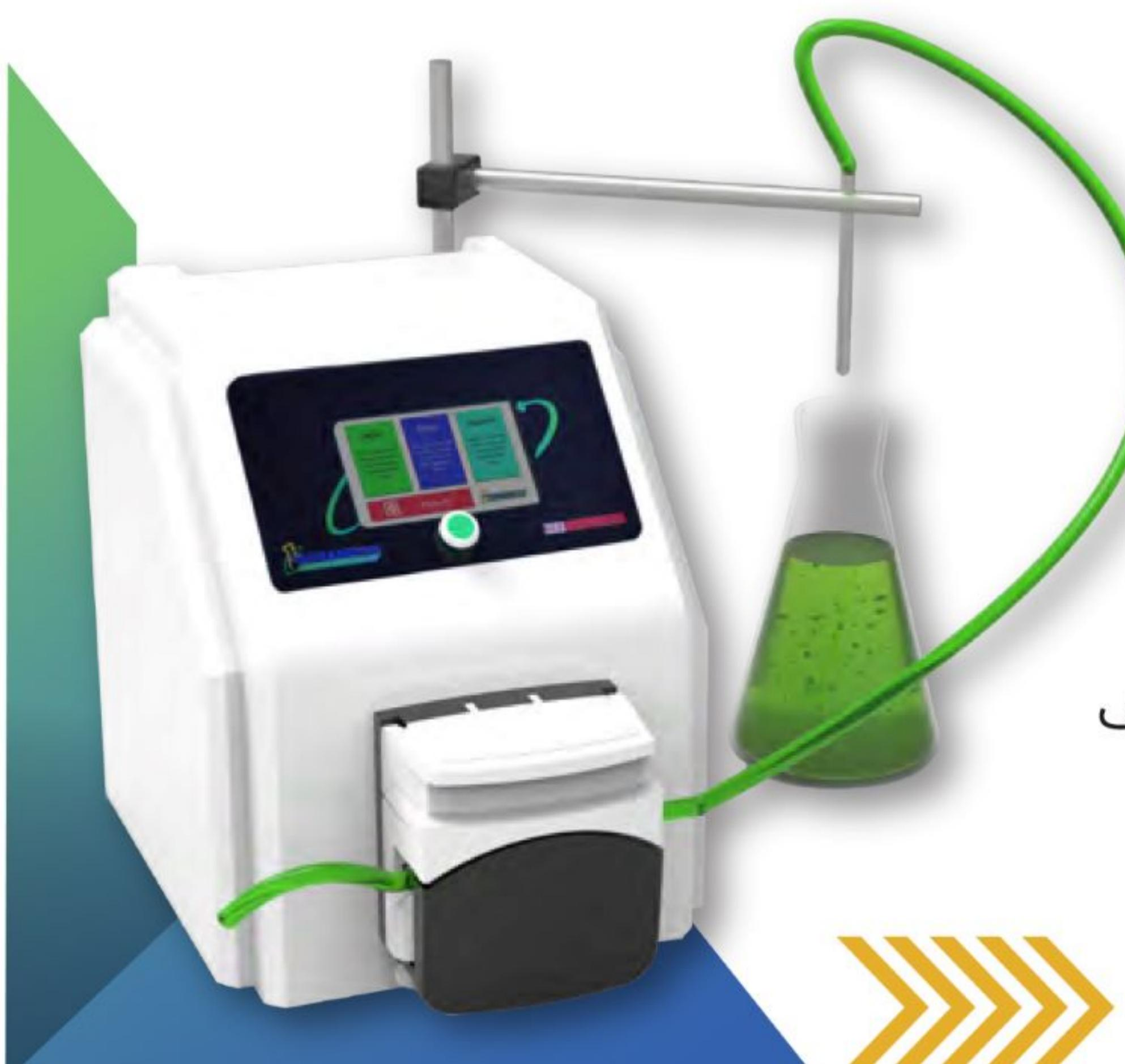
این پمپ قابلیت جایه جایی مایعات، بدون تماس با قطعات داخلی پمپ را برای کاربر فراهم میکند. جایه جایی مایعات از طریق شلنگ های سیلیکونی قابل استریل اتفاق میافتد که باعث کمترین آلودگی در اثر انتقال میشود.
