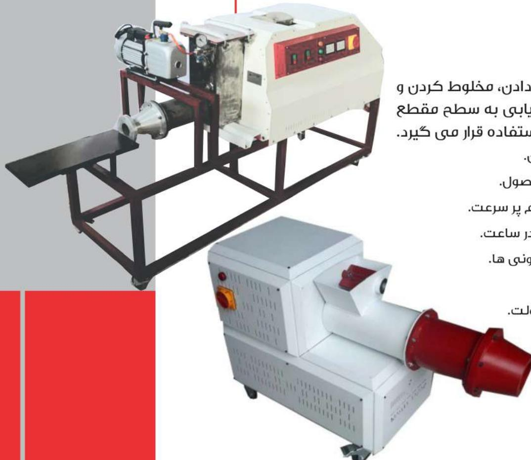
از این دستگاه برای ورز دادن، مخلوط کردن و اکسٹرود گل برای دستیابی به سطح مقطع با اشکال مختلف مورد استفاده قرار می گیرد. ظرفیت مطلوب اکسٹروژن.
