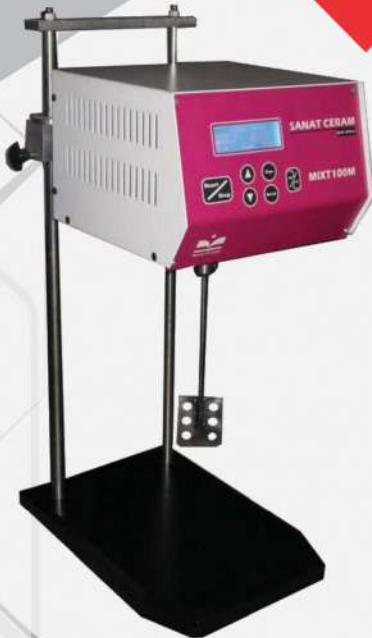
این دستگاه برای هم زدن دوغابها و محلولها در مقدار آزمایشگاهی مورد استفاده قرار می‌گیرد. سرعت، زمان و جهت دوران در این همزن قابل تنظیم است.
