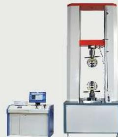
دستگاه آزمایش تست کمانش
