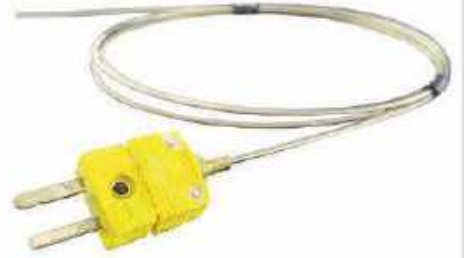
Model: MI MI Cable TC Type K (Ni-Cr/Ni) Diameter: 1.5 mm Length: 2000 mm Sheat Material: Inconel Connector: Miniatur Plug
