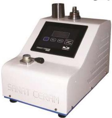
• تعیین قابلیت نفوذ گاز مواد قالب‌گیری با روش نازلی (Orifice)
