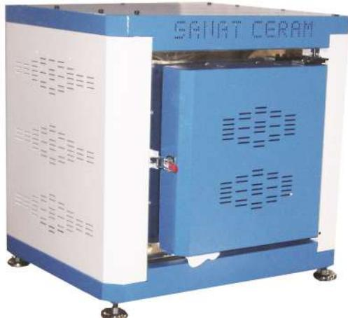
این دستگاه در انجام آزمایش‌ها و تحقیقات و گرفتن پخت سریع استفاده می‌شود. در این کوره‌ها المنتها در کف و دیواره‌ها تعییه شده‌اند و به همین دلیل یک محافظه‌داری یکنواخت ایجاد می‌شود.
