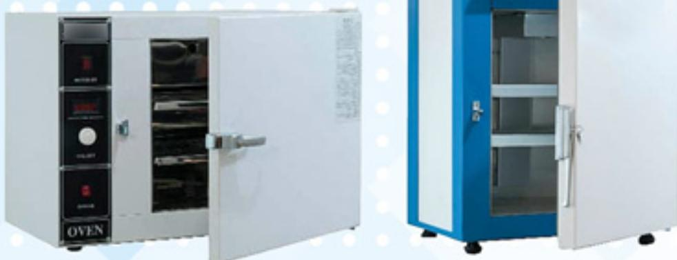
آون های آزمایشگاهی جهت خشک کردن مصالح و تعیین درصد رطوبت مصالح استفاده میگردد لازم بذکر میباشد این دستگاه در ظرفیت های  $۱۱۰$  ،  $۵۵$  ،  $۲۲۰$  لیتری و در مدل های هوشمند و دیجیتال ارائه می گردد .
