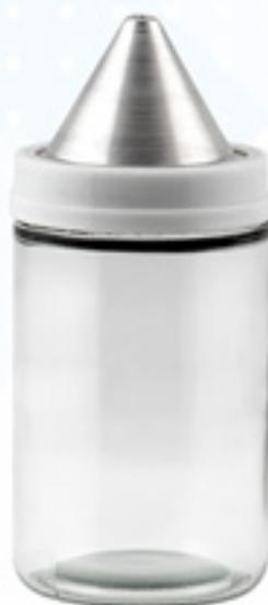
پیکنومتر بالنى شیشه ای است که جهت تعیین وزن مخصوص سنگدانه ها استفاده می شود که ظرفیت آن  $۱۰۰۰ \pm ۰/۱$  میلی لیتر می باشد و به سادگی می توان نمونه را در آن ریخت. در پوش پیکنومتر به صورت مخروط ناقص فلزی می باشد که توسط اورینگ آب بندی شده است.
