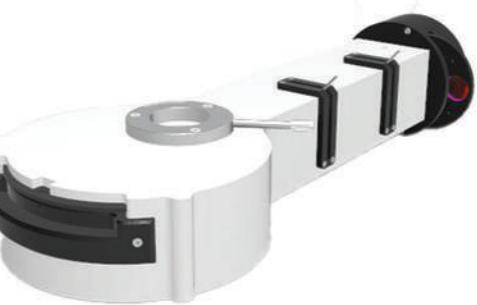
ماژول میکروسکوپ نوری به فلورسنت دارای قابلیت نورتابی یکنواخت می‌باشد. این ماژول دارای یک منبع نوری، دیافراگم روزنه و دیافراگم میدان قابل تنظیم توسط کاربر، مجموعه‌ای از فیلترهای ND و فلورسنت است. ماژول فلورسنت به گونه‌ای طراحی شده است که می‌تواند از طریق آدپتور زیرین خود روی بدنه میکروسکوپ‌های نوری Upright و Infinity-corrected و بزرگ‌نمایی (انواع برند) و شرکت‌های سازنده) قرار بگیرد، به گونه‌ای که همواره تصویربرداری نوری میکروسکوپ کاملاً حفظ می‌گردد.
