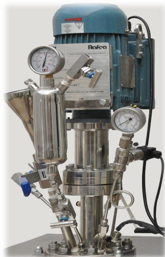
فشار ۶۰ بار و دمای ۲۵۰ درجه با دکانتر
