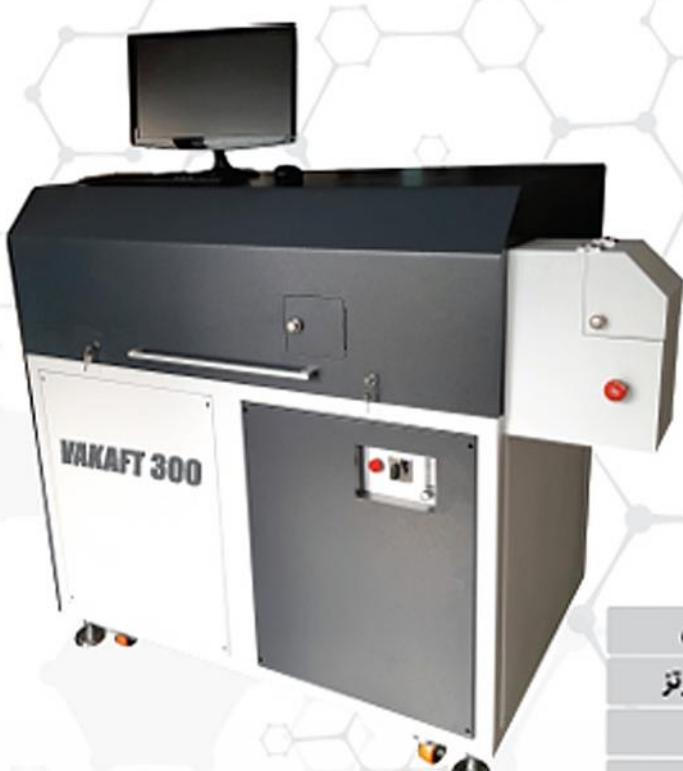
برای آنالیز نمونه های فلزی و برخی ترکیبات معدنی و کائی ها به روش دقیق و سریع از این دستگاه استفاده می شود به این روش که سطح نمونه توسط یک لیزر قوی مورد اصابت قرار گرفته و کند و پاش های سطحی نمونه توسط گاز حامل آرگون حمل شده و ولرد تورج پلاسما می شود. این نانوذرات در شعله ی پلاسما یونیزه شده طیف استاندارد عناصر تشکیل دهنده خود را تابش می کنند. طیف سنج دستگاه براساس طیف نشانی هر عنصر و گراف های کالیبراسیون آنالیز و غلظت عناصر نمونه مجھول را بدست می آورد.
